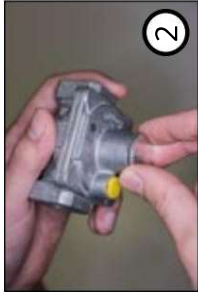
2 - ОТКРУЧИТЕ КРЫШКУ, ЧТОБЫ ПОЛУЧИТЬ ДОСТУП К РЕГУЛИРОВКЕ РЕГУЛЯТОРА.
