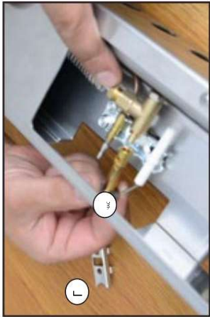
12 - Снимите запальное пламя
