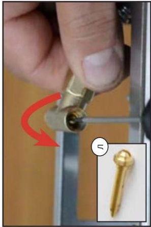
14 - Заменить сопло запальной горелки
